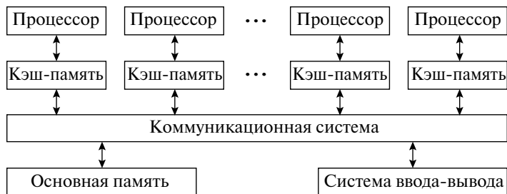
Рис. 7.8. Организация симметричной мультипроцессорной системы
