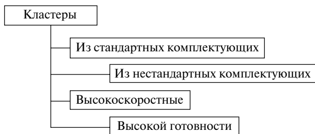
Рис. 7.11. Классификация вычислительных кластеров
