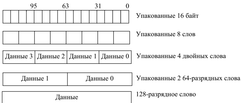
Рис. 4.10. Целочисленные данные SSE2 расширения
